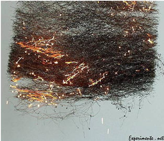
Nach der Verbrennung entsteht ein Eisenoxid.
